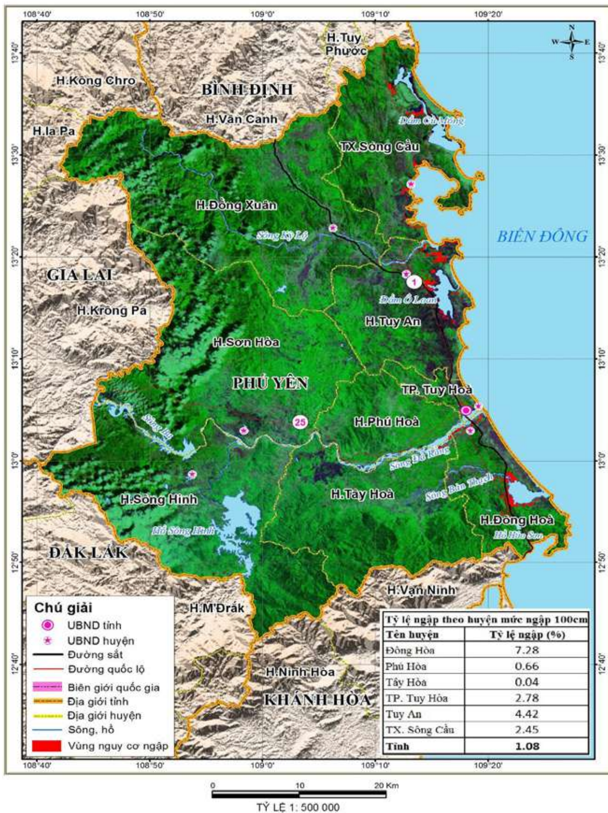
Hình C16. Bản đồ nguy cơ ngập úng với mực nước biển dâng 100 cm, tỉnh Phú Yên
